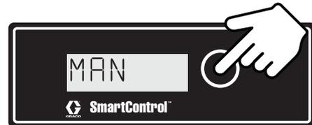
Lassen Sie die Schaltfläche los und ein Uhr-Symbol wird im unteren Bereich der Anzeige eingeblendet.
