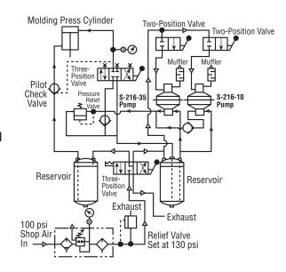
HIGH-LOW PUMP SYSTEM FOR MOLDING PRESS
